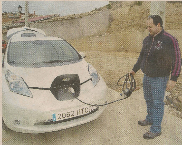
■ David Rivero muestra en Castelnou el sistema de recarga del taxi eléctrico Nissan LEAF que se compone básicamente de un cable de corriente.
